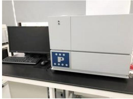
**3. 螢光高通量單細胞自動分注系統 (Cytena F. sight)**：結合微流體及影像系統，可精準的將單一細胞分離出來並分布於 384/96 孔盤中，並維持高細胞存活率。可更進一步使用細胞螢光染色，依據染色標的進行特定細胞篩選。【圖：螢光高通量單細胞自動分注系統（左圖），與轉錄後修飾矩陣分析系統（右圖）】
