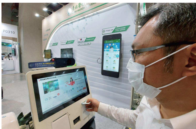
零接觸智慧防疫自助機CIS Kiosk，可提供訪客實名制管理，偵測口罩配戴、TOCC紀錄查詢及體溫量測等自助式服務。
