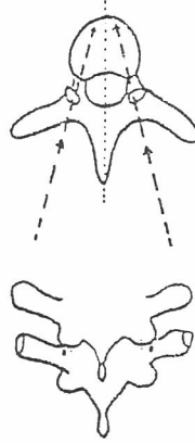
圖三：Transpedicular Screw 穿入點及角度。
