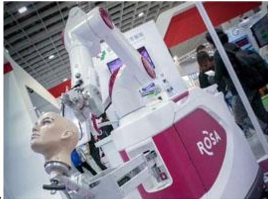
了解機械手臂如何自動追蹤患者呼吸，並穩定定位骨釘引導放置，進而避免開刀時因為呼吸造成的移動誤差。【右圖：現場展出的 ROSA 機器人手術系統】
