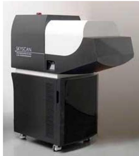
1. 搭載 90kV X-ray 射源：能量可調整於 20~90kV 間，並搭配 6 種電壓 (30keV、45 keV、50 keV、65 keV、80 keV、90 keV) 與 6 種濾鏡模式 (無濾鏡、Al 0.25mm、Al 0.5mm、Al 1.0mm、Al+Cu、Cu 0.11mm)。
