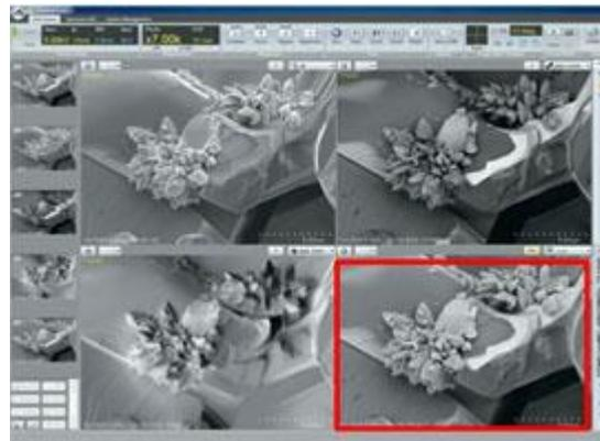
2.直觀的操作：方便的操作介面，提高觀察效率，可一次顯示 4 種訊號。同一視圖的多個信號可以任意混合，並顯示為一個組合的及時圖像。允許多個信號在一個圖像中有效的像分析用。例如，二次電子（SE）的表面信息和背散射電子（BSE）成份組成信息的混和圖像（上右圖中紅框）。
