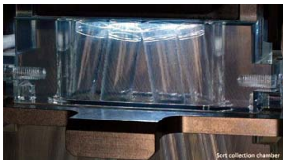
【圖：左為FACS Aria III新穎之X型光路設計版；右為細胞收集裝置（最多可同時蒐集四群細胞）】
