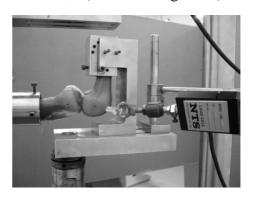
先施以垂直加力於脛骨,以50mm/min 的速度,施以向後移位(posterior translation)的力,施力到140N為止,記錄其LOAD CELL的應力。並觀察各小組移植物的變化.
