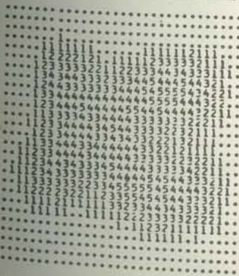
以電腦分析染色體，使自動檢查大量細胞染色體中的異常成爲可能。左上圖爲人類染色體的顯微相片。右圖爲顯微相片以數字顯示在電腦輸出卡上。左下圖爲其中一個染色體的放大圖。
