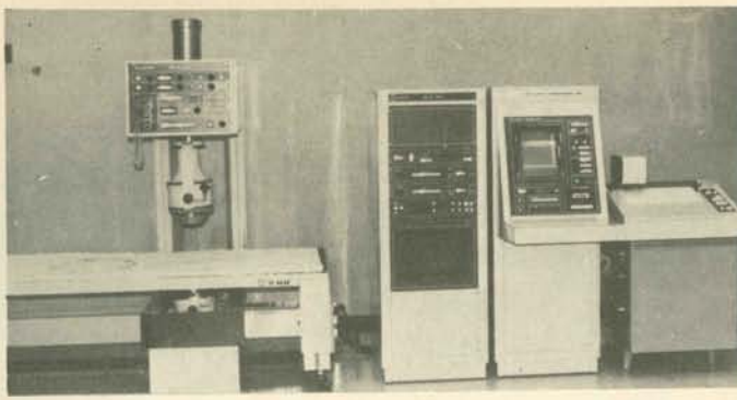
圖十四 全身骨骼掃描機：圖中右一為彩色滙點記像器 圖右二為電視顯像及錄影器
