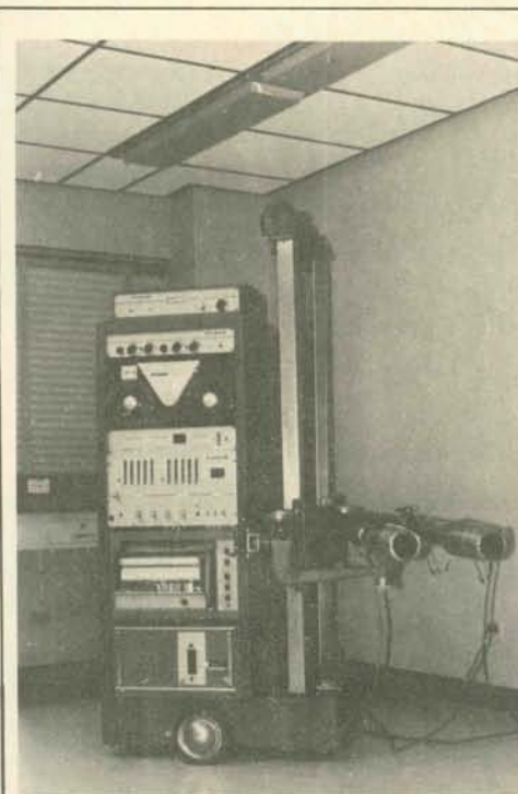
圖十三 1. 甲狀腺體碘攝取功能測定機
