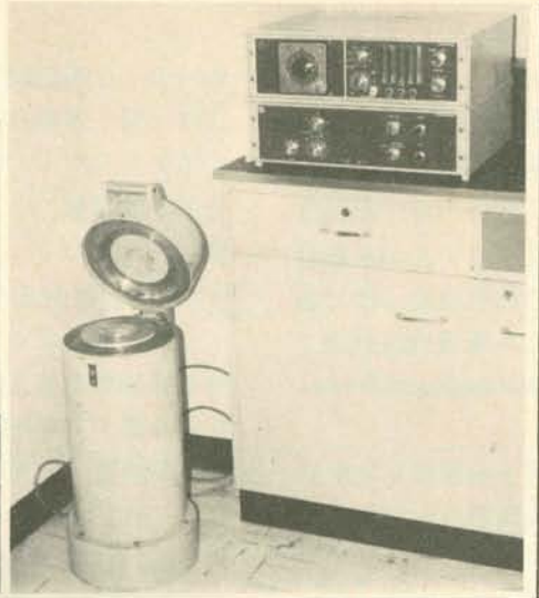
圖十一 伽瑪射線計數器：右為老式手動，左為自動式可一次計數200個標本。
