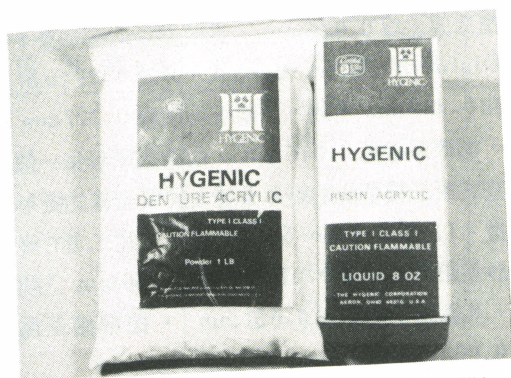
圖 11 本實驗所用的樹脂。根據說明書，可以用 100°C 沸水加熱聚合，亦可以用傳統加熱方式聚合。
