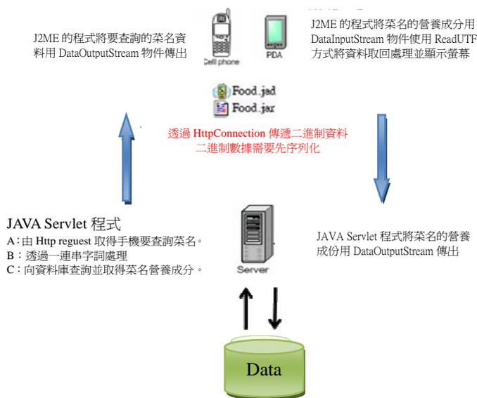
Figure 2：手機端與伺服器端溝通技術圖
